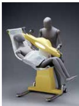
ベッド・車椅子間の移乗を軽い負担・シンプルな操作で介助できるよう移乗をアシストするロボットです。
